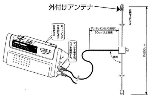
外付けアンテナの取り付け方
